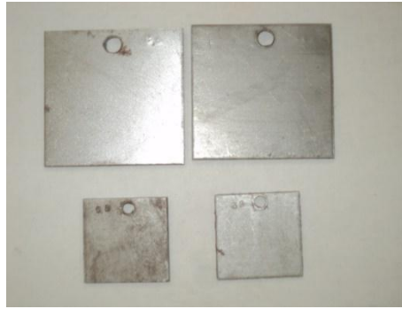
Hình 2.2: Mẫu thử nghiệm ăn mòn theo phương pháp tổn hao khối lượng và quan sát bề mặt vi mô
