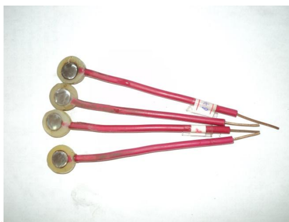
Hình 2.1: Cấu tạo điện cực làm việc
