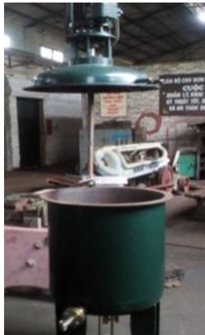
Hình 4.8. Tháo nắp hiệu chỉnh thiết bị
