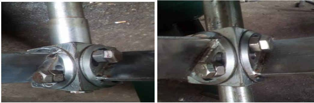
Hình 4.10. Chỉnh khoảng cách cánh khuấy tới đáy thùng + Bước 2: Lắp hoàn thiện thiết bị, chạy thử không tải, hiệu chỉnh tốc độ khuấy theo thí nghiệm và thời gian khuấy là 70s.
