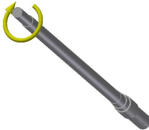
Hình 3.5. Mô hình trục mang cánh khuấy với mô men xoắn trên trục
