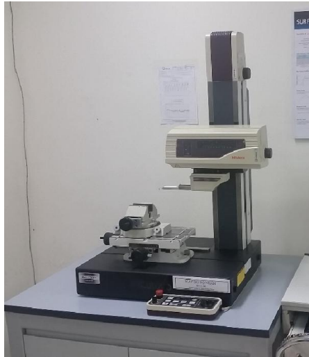
Hình 18. Hình ảnh máy đo nhám Mitutoyo SV-3100 tại công ty FUTU 1
