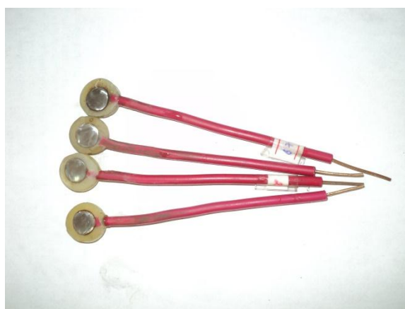
Hình 2.1: Cấu tạo điện cực làm việc
