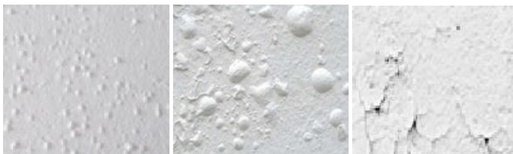
Hình 3.22: Các dấu hiệu trên bề mặt mẫu ngâm trong dung dịch axit HCl 1N theo thời gian
