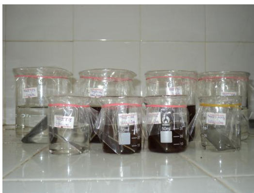
Hình 2.3: Ngâm mẫu thử nghiệm ăn mòn theo phương pháp tổn hao khối lượng, phương pháp phân tích và phương pháp quan sát bề mặt vi mô
