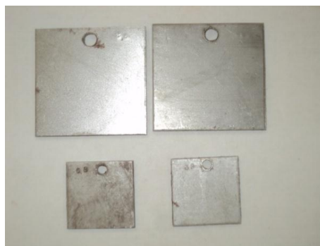
Hình 2.2: Mẫu thử nghiệm ăn mòn theo phương pháp tổn hao khối lượng và quan sát bề mặt
