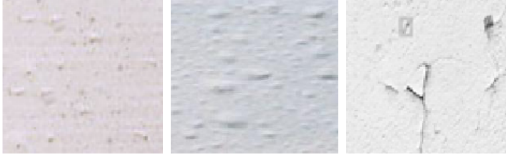
Hình 3.23: Các dấu hiện trên bề mặt mẫu ngâm tổng dung dịch NaCl 3% theo thời gian
