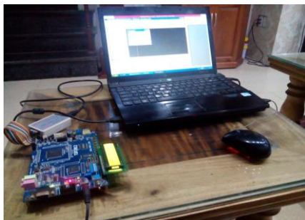
Hình 3.44. Kết nối máy tính PC với Board nạp code cho TMS320F2812
