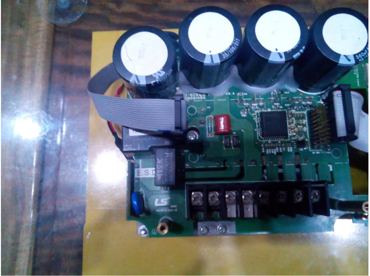
Hình 2.20. Board mạch lực hệ thống
