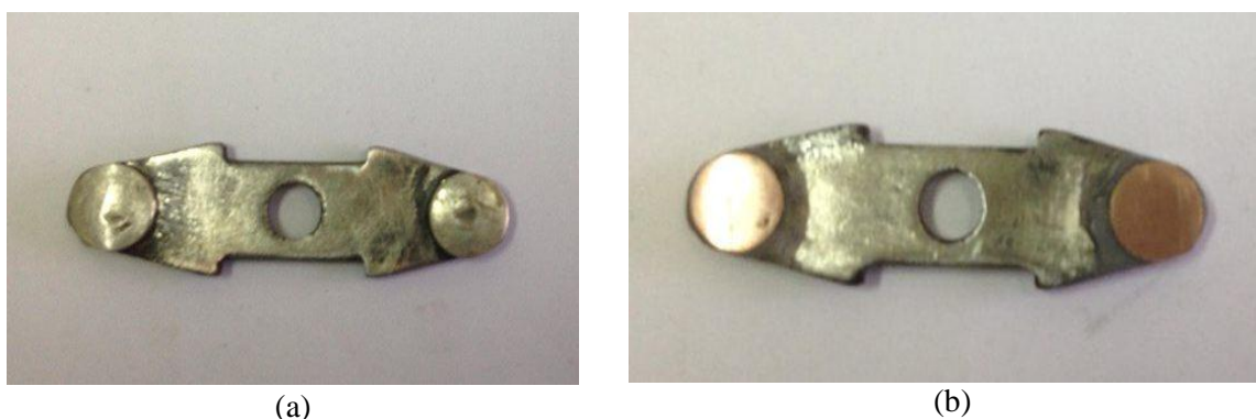
Hình 4.3. Hình ảnh tiếp điểm điện trong tủ điều khiển máy bào giường
