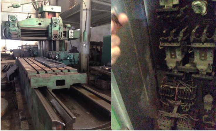
Hình 4.4. Hình ảnh máy bào giường và tủ điều khiển của máy bào giường.
