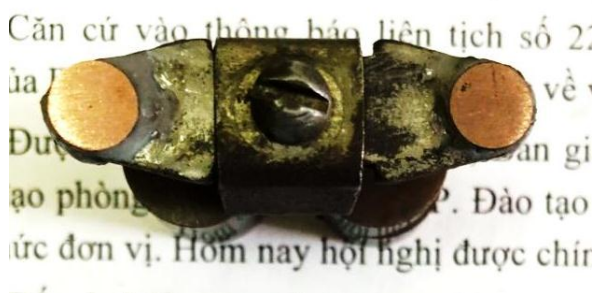
Hình 4.8. Hình ảnh tiếp điểm điện composite nền Cu cốt hạt TiC sau 1000 lần đóng ngắt.
