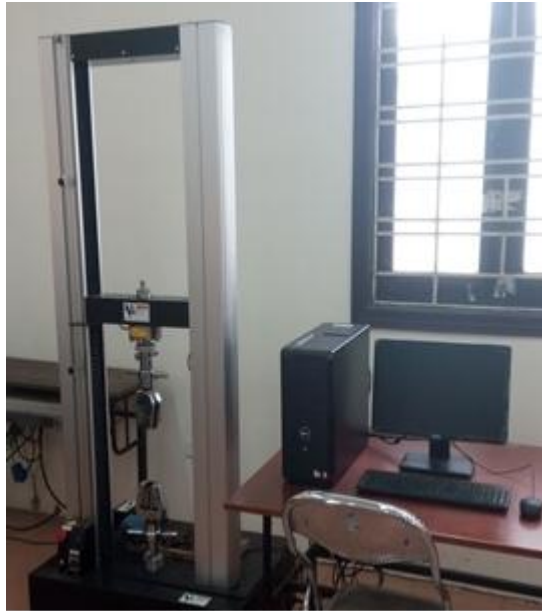
Hình 2.21. Máy thử cơ tính vạn năng (Nhà sản xuất: GUNT, Model: WP310)
