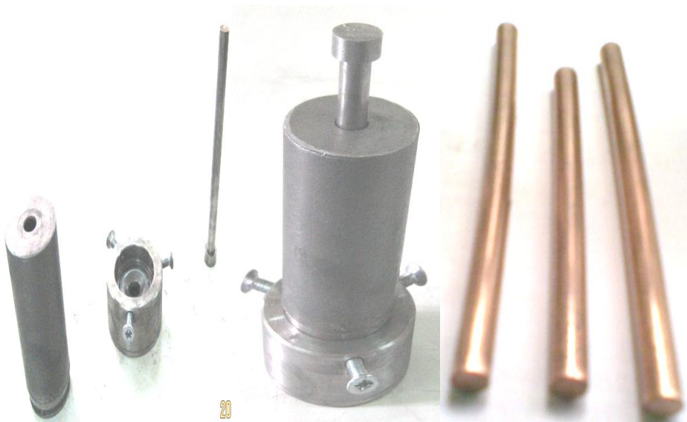
Hình 4.4. Bộ khuôn ép đùn và sản phẩm sau quá trình ép đùn nguội
