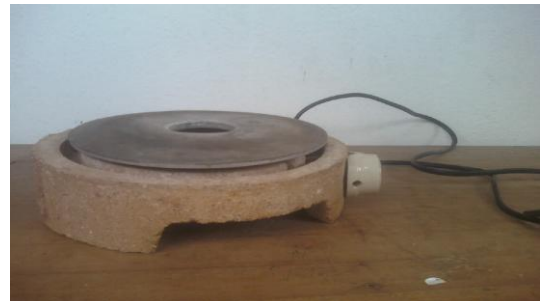
Hình 3.19. Bếp điện do HS lắp ráp từ linh kiện cũ
