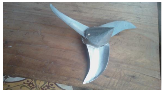
Hình 3.8. Tua bin gió HS chế tạo từ sắt tây
