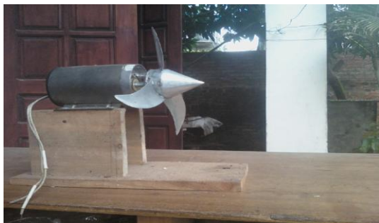
Hình 3.7. Máy phát phong điện do HS lắp ráp
